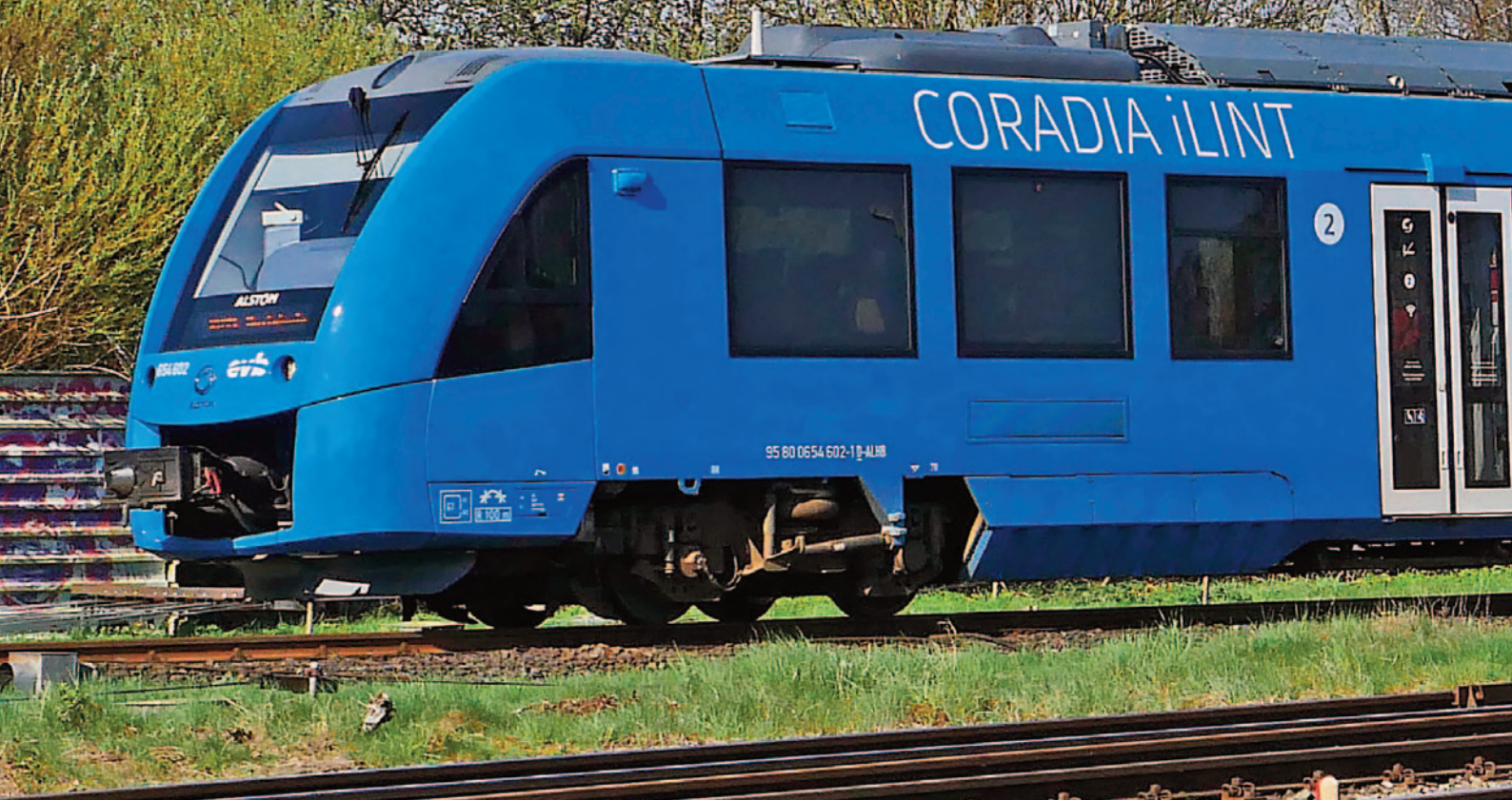
Coradia iLint, regionaltåg som drivs av vätgasbränsleceller.
